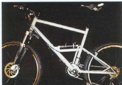
Beim **Koxinga LT** werden die 3 Hauptrohre TIG-geschweisst. Es ist auch in Custom-Grössen erhältlich. Das **CLT** ist die Fillet Brazed Version und verfügt über einen leichteren Rohrsatz. Damit wird aus dem Koxinga CLT ein Freerider, der leichter als die meisten Cross Country Rennbikes ist. Für Hardcore-Freerider gibt es das **XLT**: optisch wie das LT, aber mit extraviel Federweg.
